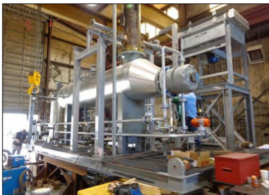
Glycol Regen Skid
